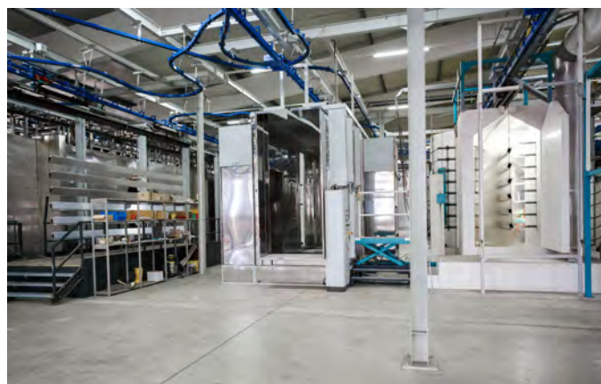
Die hochmoderne Anlage mit der Spritzkabine (rechts) ermöglicht eine Pulverbeschichtung von Serienteilen bis zu großen Bauteilen bei gleichbleibender Qualität. Fotos: Römer
